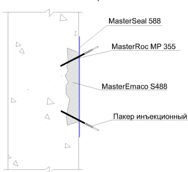
Локальный ремонт бетона с применением метода инъектирования
